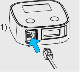
До активации счетчика вставьте кабель сенсора в гнездо выносного дисплея
