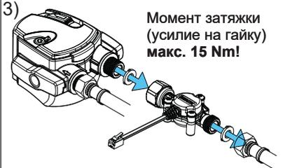
Момент затяжки (усилие на гайку) макс. 15 Nm!
